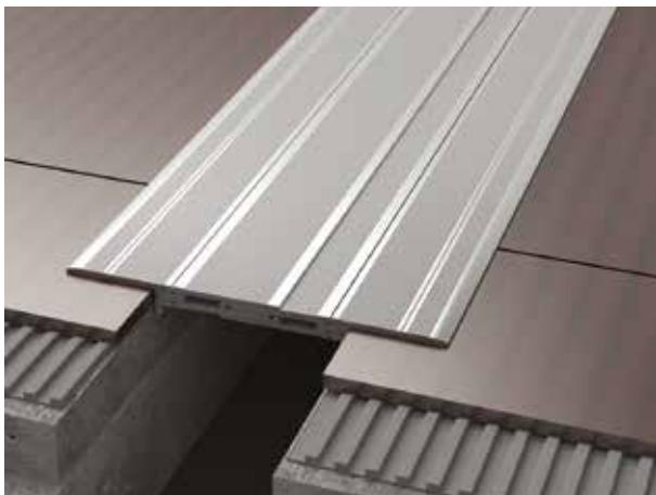
Joints structurels pour sols avec les éléments portants en aluminium. Conçus pour permettre les mouvements structurels d'ensembles de bâtiments ou de bâtiments de grandes dimensions. Installés dans les espaces libres entre deux parties dissociées d'un même bâtiment ou entre deux travées différentes. Ils peuvent réunir cet espace intermédiaire en permettant des mouvements horizontaux, verticaux et de déplacement, causés par les tassements du bâtiment de façon ponctuelle ou permanente.
